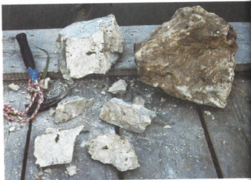
Abb. 16: Kalksteinbrocken mittlerer Größe aus der Verfüllung von Pfeiler 6.
