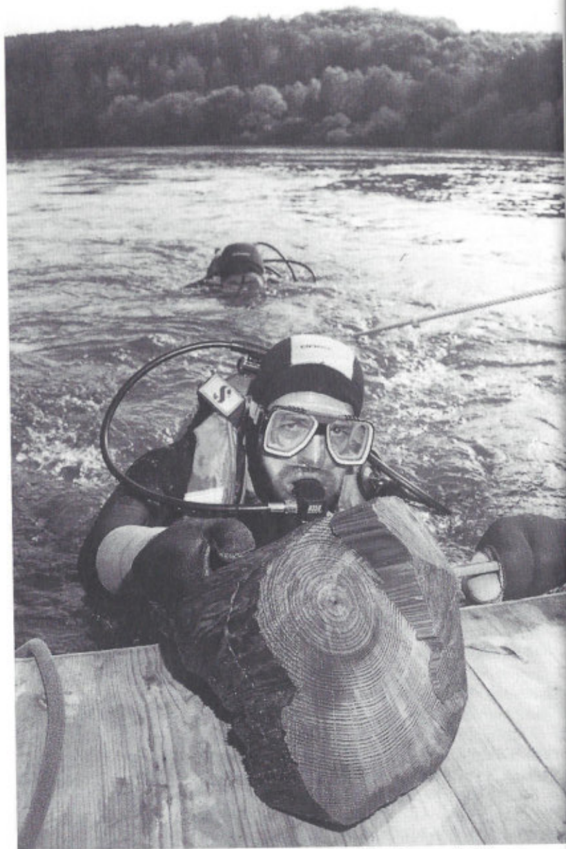
Abb. 15: Taucher bei der Bergung eines Pfahlkopfes von Pfeiler 4.
