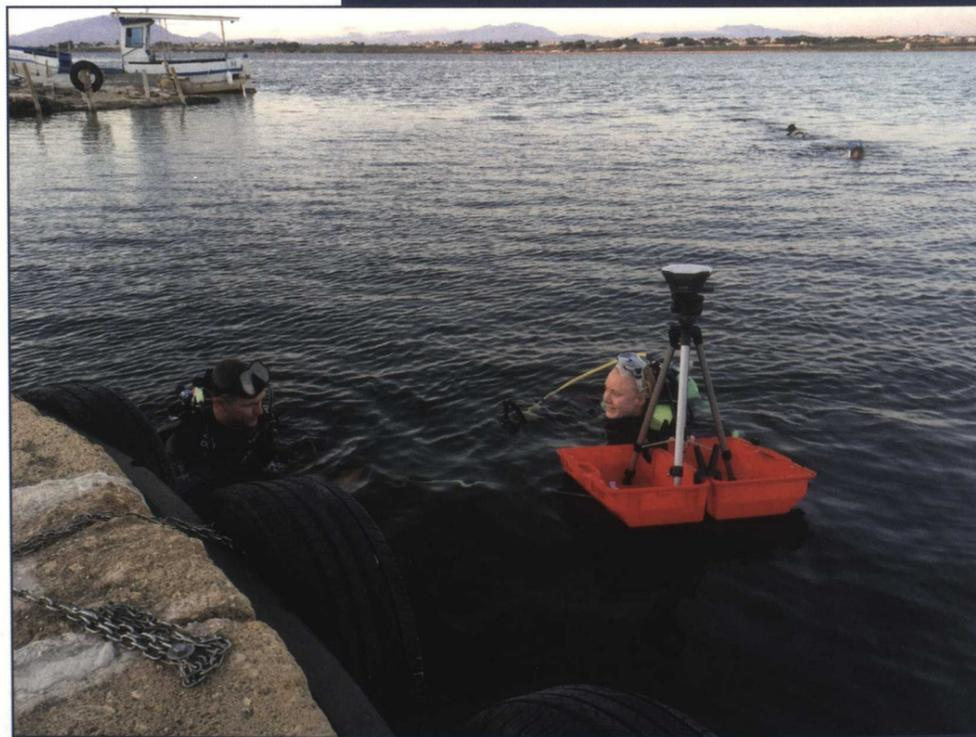
Abb. 2: Boje bestehend aus einem verstärkten Leica-Vermessungskoffer mit Stativ, an dem der Rover (Emlid Reach) montiert wurde
