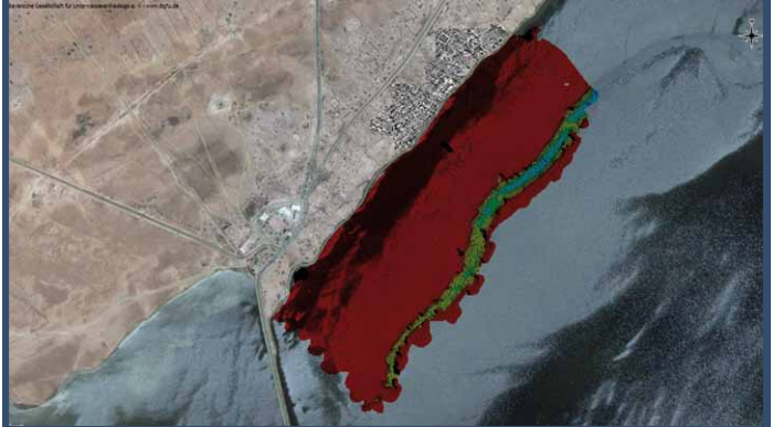
Abb. 3: Bathymetrische Karte, erstellt mit Sidescan-sonar-Technik
