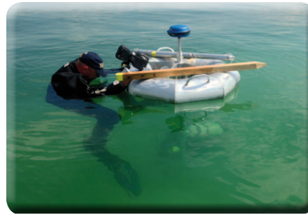
Abb. 1: Installation des Vermessungssystems durch die Firma Schlimper. Foto: BGFU
